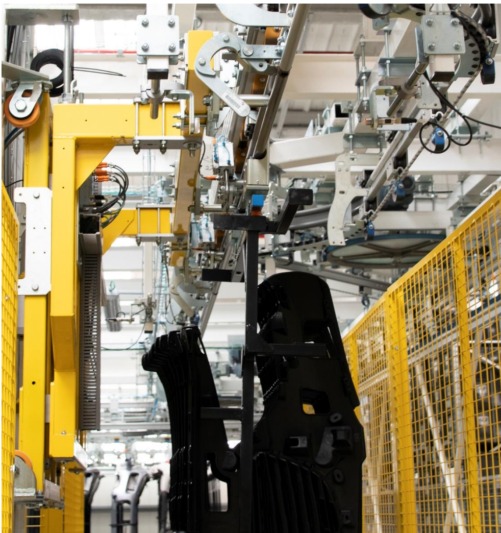
Cambio de nivel con elevador
